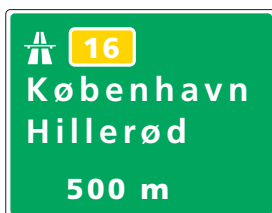
I 17: 500 m frakørselstavle for forbindelses-anlæg til anden motorvej.
